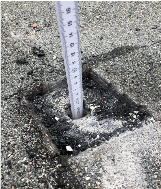
Abb. 2: Detailansicht Entnahmestelle des Betons Probe M8 (unter Dachpappe + Kleber)
